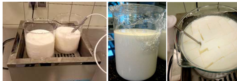
Fot. 1. Pasteryzacja mleka w kąpeli wodnej, 74° C, 15 sekund
