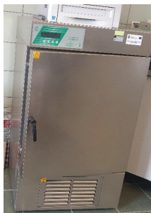
Fot. 9. Fermentacja w inkubatorze z funkcją chłodzenia (4,5godziny/45°C) następnie ochłodzenie do 5°C
