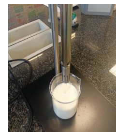
Фото 4. Гомогенізація молока під тиском 20 МПа протягом 15 секунд
