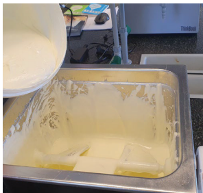
Fot. 5. Przelanie dojrzałej fizycznie śmietanki do masielnicy, śmietanka na 1 godzinę przed rozpoczęciem zmaśniania doprowadzona była do temp. 7-10°C
