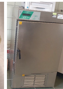
Фото 9. Скважування в інкубаторі з функцією охолодження (4,5 год/45°C) з наступним охолодженням до 5°C
