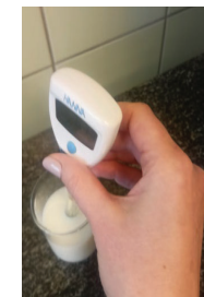
Фото 6. Визначення значення pH молока.
