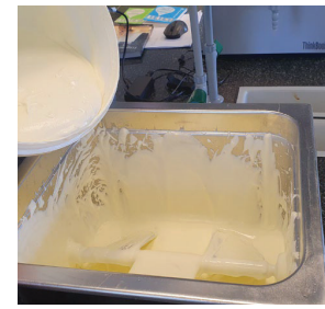
Фото 5. Переливання фізично дозрілих вершків у маслоготовлювач, за 1 годину до початку сколочування вершки були доведені до температури 7-10°C влітку та 10-14°C взимку.
